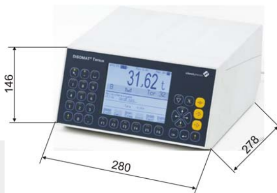
Tischgerät VTG 20450 Schutzart: IP54, Kunststoff, 10 Kabeleinlässe inkl. Netzanschluss und Wägezellenkabel Gewicht: 3,7 kg
