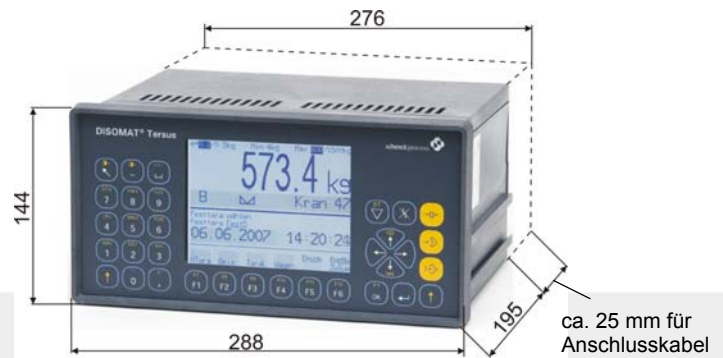
Einbaugerät VEG 20450 Schutzart: Front IP54, sonst IP 20 Kunststoff, Schalttafel ausbruch 138,5 x 282 mm Gewicht: 3,5 kg
