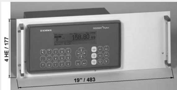
19" Baugruppenträger VNG 20450 mit Einbaugerät VEG 20450 Tiefe 195 mm + 25 mm für Anschlusskabel Schutzart: Front IP 54 sonst IP 20 Gewicht: 7,5 kg
